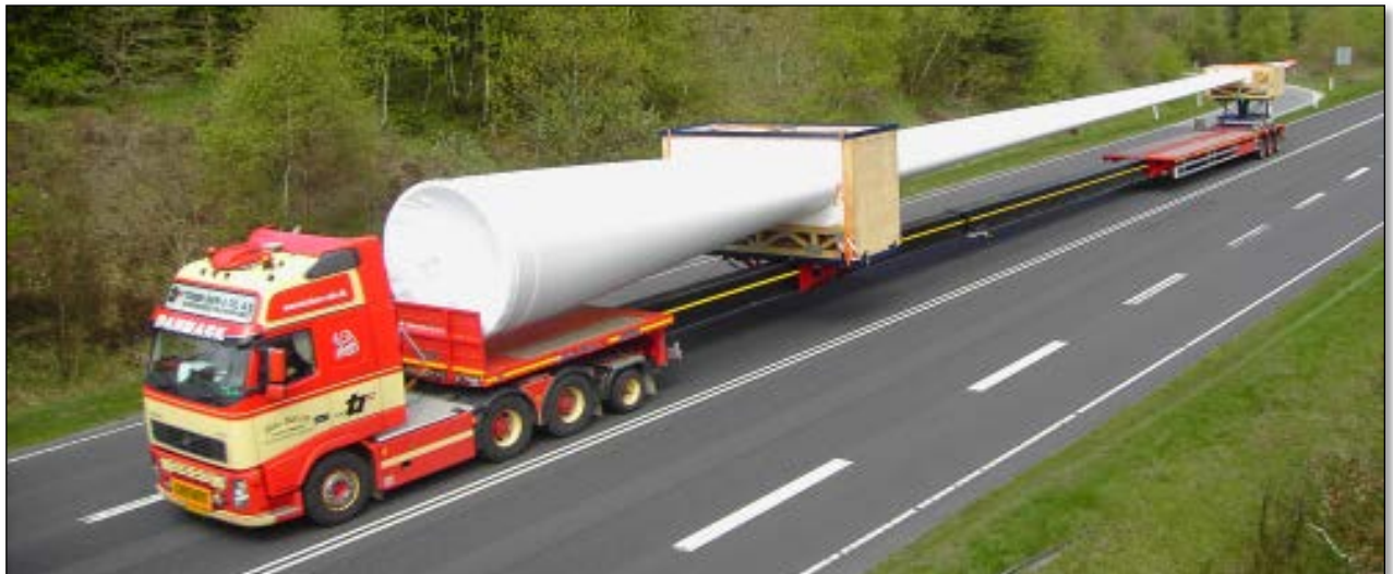
Figur 6-6. Frakt av rotorblader stiller store krav både til kjøretøy og infrastruktur (horisontal- og vertikal-radius på veier). Foto: Nordex.
