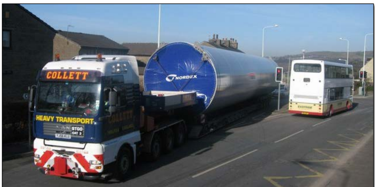
Figur 6-5. Frakt av tårn med spesialkjøretøy. Foto: Nordex.
